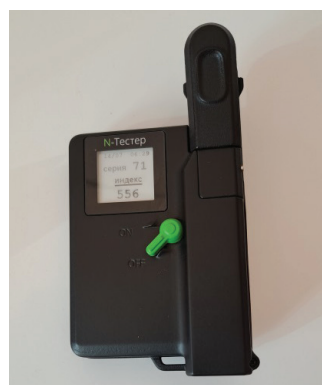
Рис. 1. N-тестер модель ПРАК 431155.022 Fig. 1. N-tester model PRAK 431155.022
