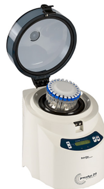
Рис. 1. Гомогенизатор Bertin Precellys 24, измельчающий растительные образцы, погруженные в CTAB-буфер, при помощи керамических шариков, вакуума и 3D-вращения Fig. 1. Homogenizer Bertin Precellys 24, which grinds plant samples immersed in the CTAB-buffer using ceramic balls, vacuum and 3D rotation
