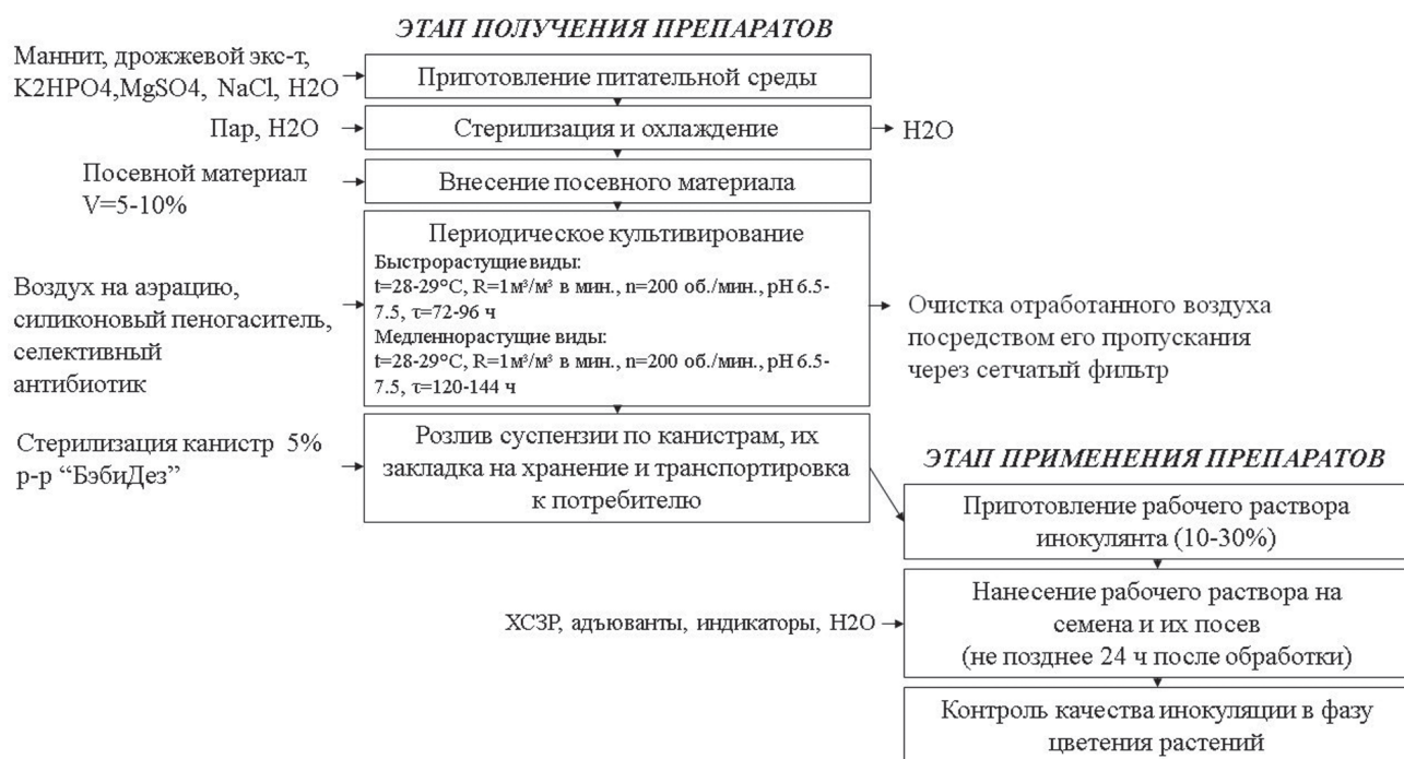
Рис. 1. Общая технологическая схема получения и применения инокулянтов на основе клубеньковых бактерий Fig. 1. General technological scheme for the production and use of inoculants based on nodule bacteria
