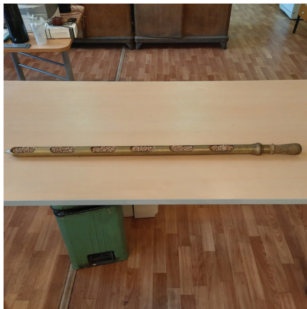
Рис. 2. Шестиуровневый щуп-пробоотборник Fig. 2. A six-level probe-sampler
