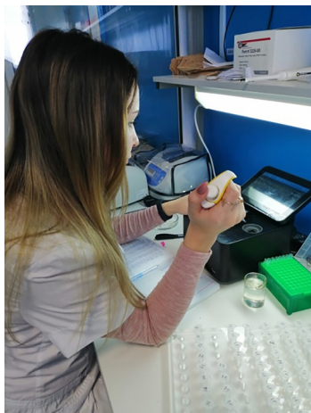
Рис. 2. Оценка количества и качества выделенной ДНК при помощи спектрофотометра Implen NanoPhotometer NP80.
